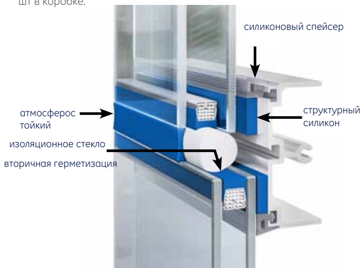
Типичная конфигурация стеклопакета
