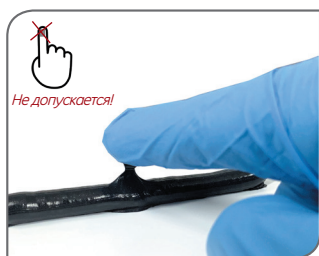
Рис. 21 Тест на поверхностное пленкообразование - ДО ОТЛИПА
