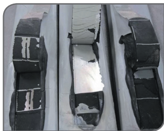
Рис. 22 Тест на адгезию на трех образцах
