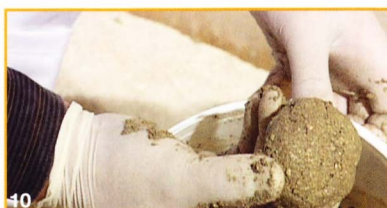
Чтобы проверить раствор на пластичность, его необходимо скатать в шар при этом он должен разваливаться
