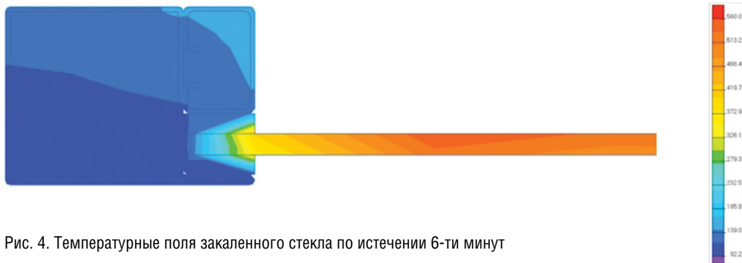
Рис. 3. Температурные поля закаленного стекла через 6 минут
