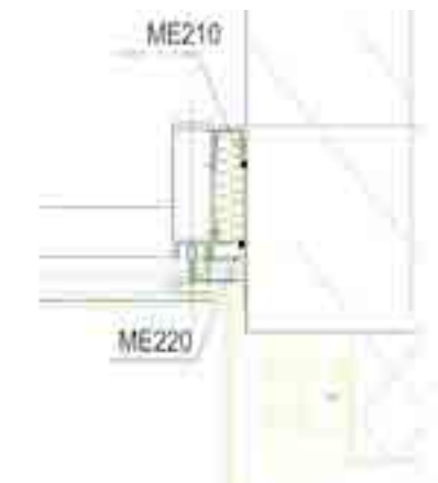
ME220 Наружная EPDM мембрана ME210 Внутренняя бутиловая мембрана OT015 Клей для мембран
