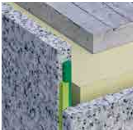
SP523 Гибридный герметик (с забутовочным шнуром)
