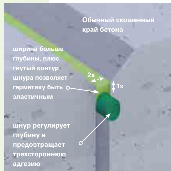
Шов сборных железобетонных панелей
