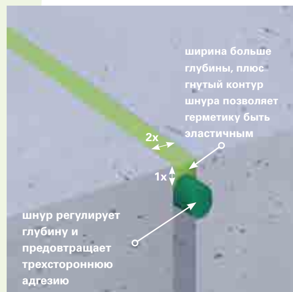
Шов в бетонном полу
