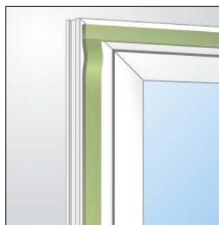
В угловых стыках отрезайте ленту на 10мм/м больше.
