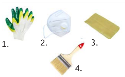
Рис.7 Инструмент для нанесения грунтовки
